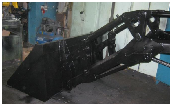
Строительный ковш объемом 0,4 м 3 , установленный на фронтальном погрузчике трактора МТЗ
